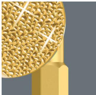
Die winzigen Diamantpartikel, die auf der Werkzeugspitze aufgetragen sind, beißen sich förmlich in der Schraube fest und sorgen für einen passgenauen und rutschfesten Sitz im Schraubenkopf. Durch diesen sicheren Sitz wird die Schraube geschont. Die Cam-Out-Kräfte (Ausrutschkräfte), die den Anwender zwingen, hohen Druck auf die Schraube auszuüben, werden erheblich reduziert.
