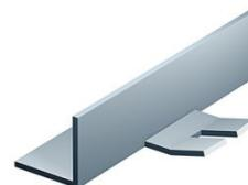
Maueranker am senkrechten Schenkel nach außen weisend angeschweißt
